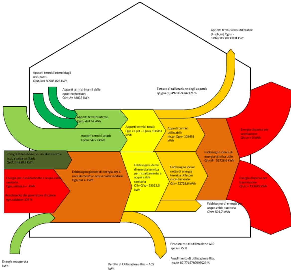
Dall'analisi dei diagrammi di Sankey relativo al fabbisogno termico dell'edificio post intervento è possibile notare che aumenta il rendimento di utilizzazione del riscaldamento, ma allo stesso tempo aumentano le dispersioni per ventilazione e per trasmissione.
