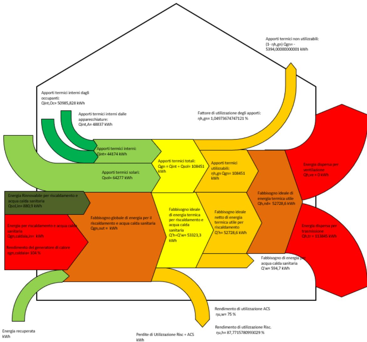
Dall’analisi dei diagrammi di Sankey relativo al fabbisogno termico dell’edificio post intervento è possibile notare che aumenta il rendimento di utilizzazione del riscaldamento e diminuiscono apporti interni termici e solari.
