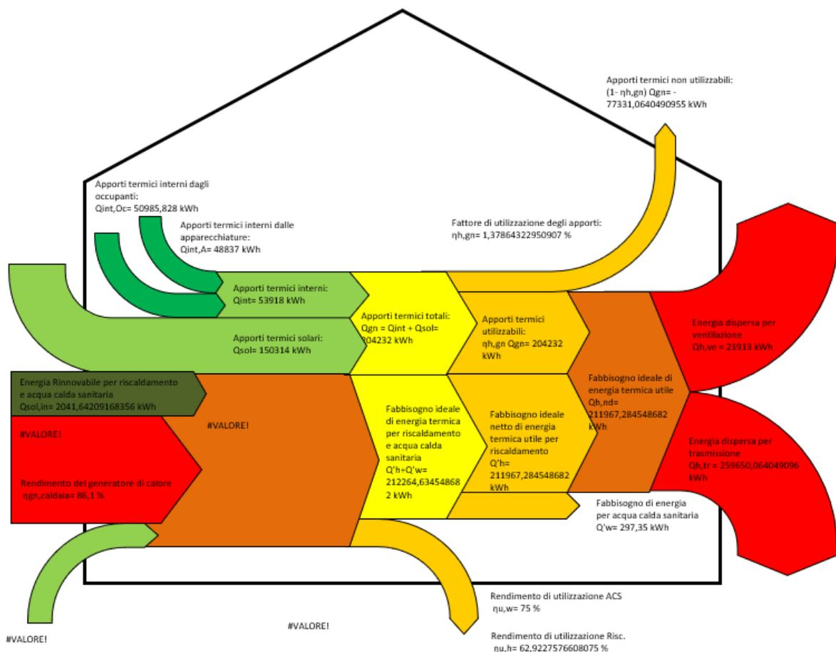
Dall'analisi del diagramma di Sankey relativo al fabbisogno termico dell'edificio è possibile notare che l'edificio presenta dei rendimenti globali medi stagionali bassi per riscaldamento. Questo è facilmente intuibile se consideriamo il fabbisogno globale di energia per riscaldamento e acs. Le perdite per ventilazione e trasmissione risultano molto alte, e questo rispecchia lo stato di fatto dell'immobile.
