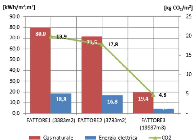
Figura 5.5 – Ripartizione % dei consumi di energia primaria e delle relative emissioni di CO<sub>2</sub>
